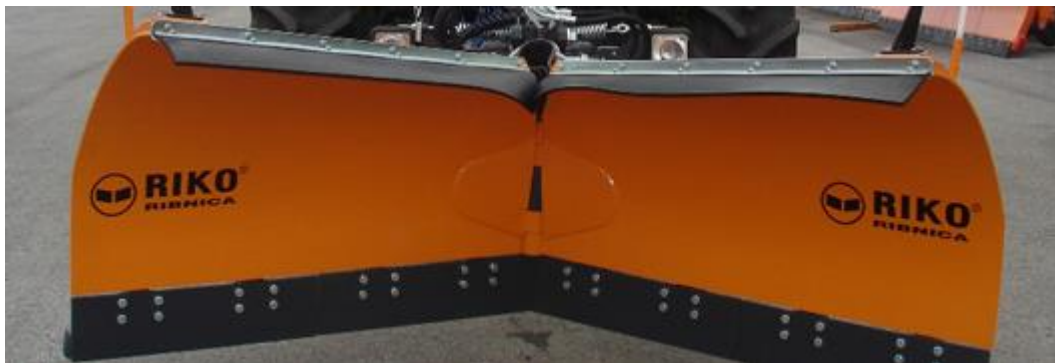
Слика 34. „V“ облик на променлив плуг
