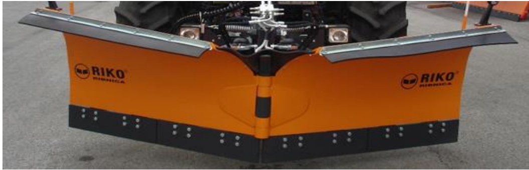
Слика 32. Клинеџ облик на променлив плуг
