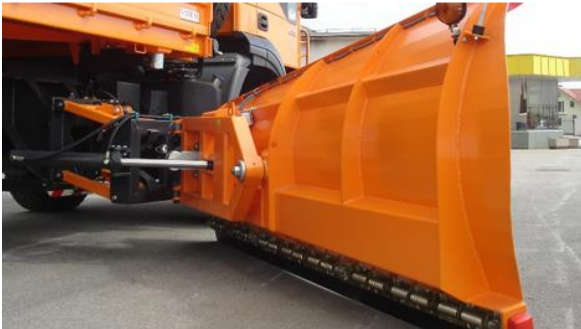
Слика 31. Снежен плуг монтирн странично на камионот Figure 31. Snow plow fitted to the side of the truck
