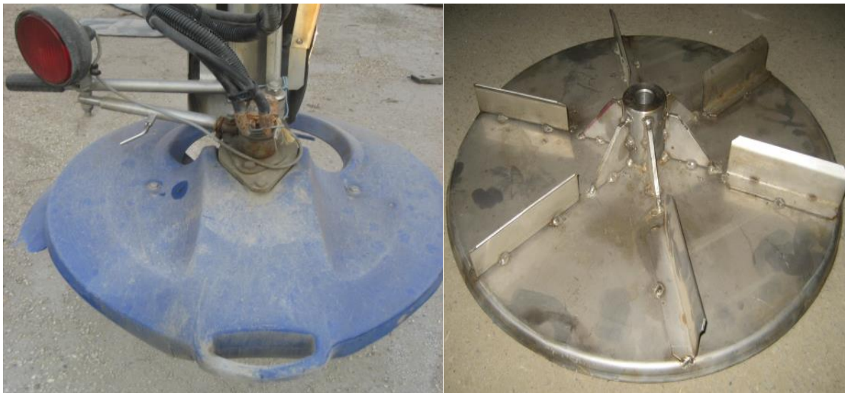
Слика 27. Ротирачка чинија и диск за посипување
