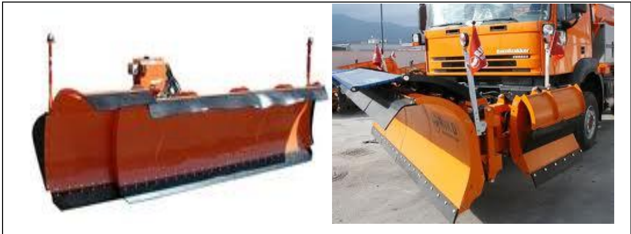
Слика 35. Плугови со променлива широчина (телескопски и со преклопување) Figure 35. Ploughs variable width (telescopic and folding)
