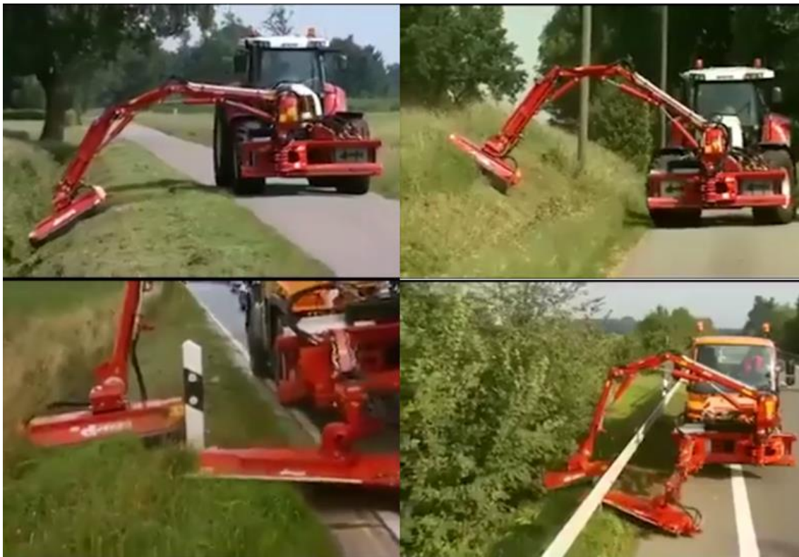
Слика 22а. Трактор со можност за користење на приклучоци
