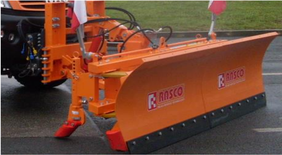
Слика 30. Снежен плуг монтирн на предниот дел на камионот Figure 30. Snow plow mounted on the front of the truck
