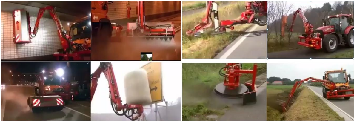
Слика 22б. Трактор со можност за користење на приклучоци Figure 22b. Tractor with the possibility of using plugs
