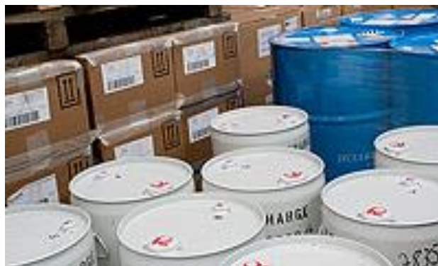
Сл. 14 Пакување според АДР Figure 14: Package according to ADR
