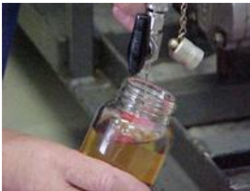
Слика 3: земање на примерок од вентил
