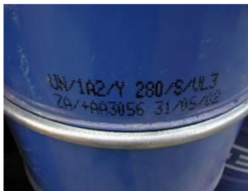
Слика 12: Втиснато одобрение од ОН Figura 12: Pressed approval of the OH
