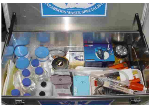
Слика 5: пример за опрема за земање примерок Figure 5: example of equipment taking oil samples
