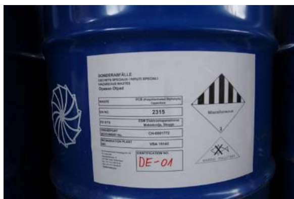
Сл. 13: Налепница за класификација на опасна материја Figure 13: Label for classification of dangerous goods
