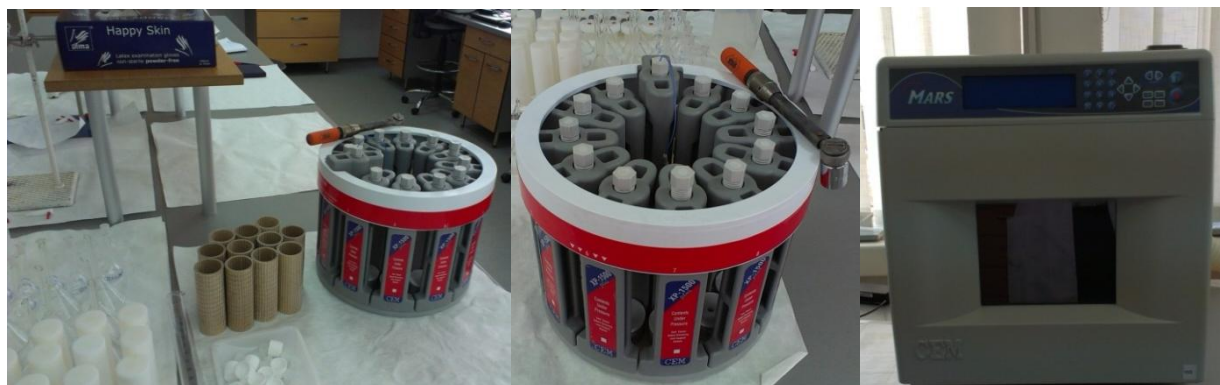
Слика 4. Подготовка на пробите за разложување во микробранова печка
