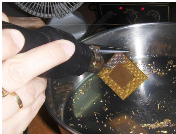
Slika 1 Uklanjanje pinova sa fiber CPU pomoću vrelog vazduha zagrejanog na 500 °C
