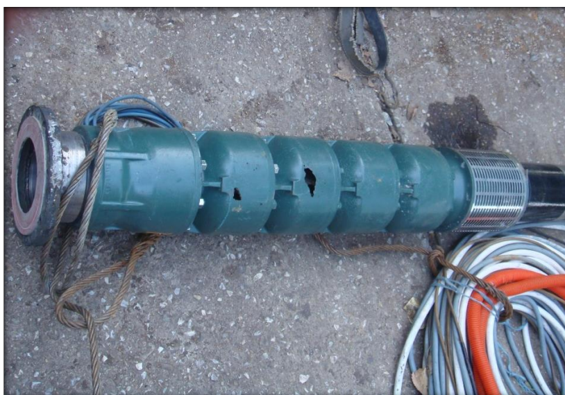
Слика 4. Оштетување на куќиште од пумпа заради хемизам на водата
