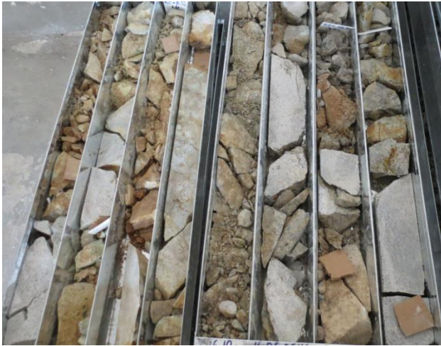
Слика 4. Половина од пресеченото јадро за документација
