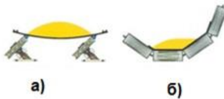
Слика 5. Положба на материјалот во лентата при водење во хоризонтална кривина а) транспортер со влечни јажиња; б) класичен транспортер
