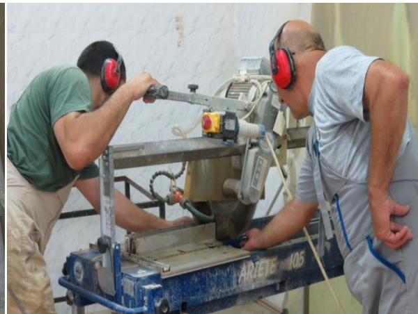
Слика 8. машина за сечење на јадро марка ARIETE 105-ITALI
