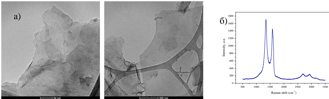
Слика 4. а) ТЕМ фотографии од графенскиот примерок GAE1; б) GAE1 Раман спектар. Добиената вредност N за број на слоеви на графенот е во согласност со вредноста за број на слоеви добиена од модел (1). Пресметаната вредност за L_a за примерокот GAE1 изнесува 4.16 nm.
