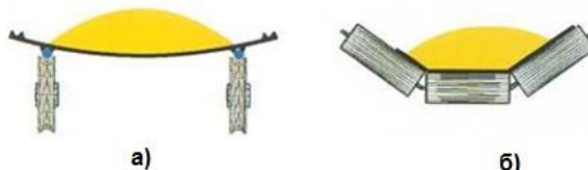
Слика 4. Положба на лентата во однос на нејзината подолжна оска: а) транспортер со влечни јажиња; б) класичен транспортер
