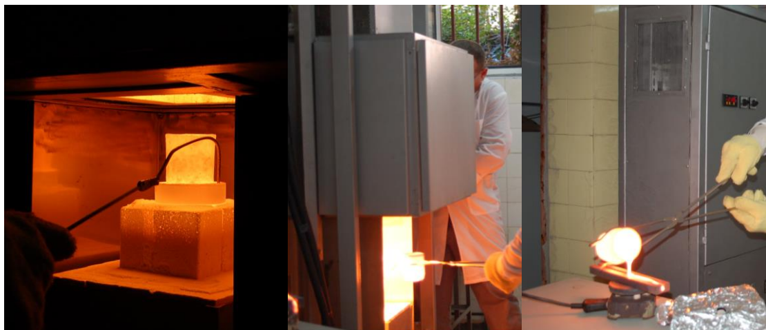
Слика 2. Детали од топењето на стаклото во коморна печка
