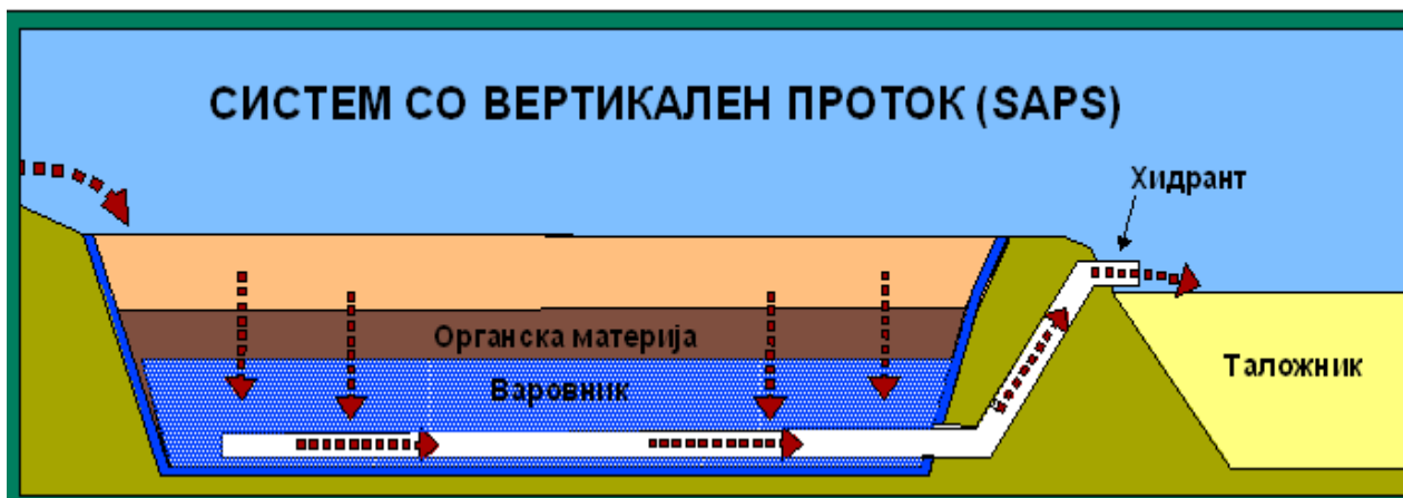
Слика 23. Поедноставен напречен пресек на систем со вертикален проток Figure 23. Simplified cross-sectional view of a simple vertical flow treatment system
