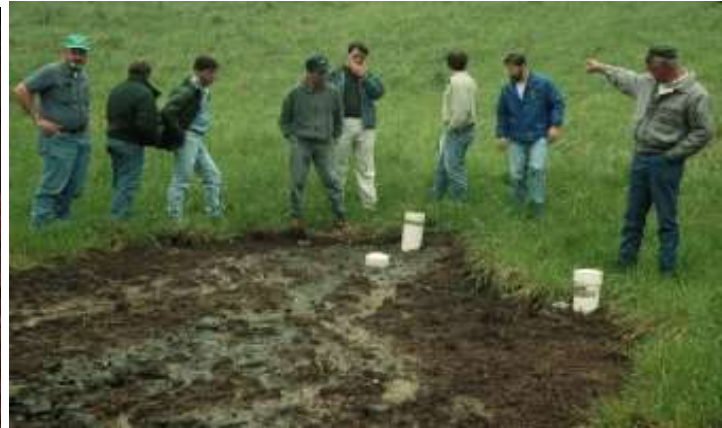
Слика 16. Вода избива во предниот дел на ALD Figure 16. Water breaks out at the front of the ALD
