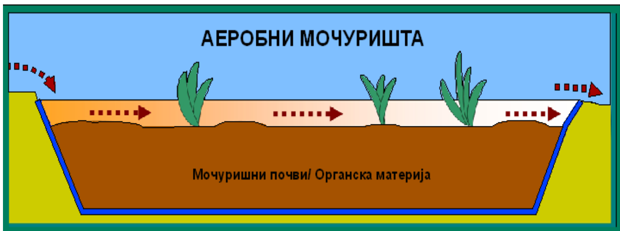
Слика 4. Поедноставен напречен пресек на аеробно мочуриште.
