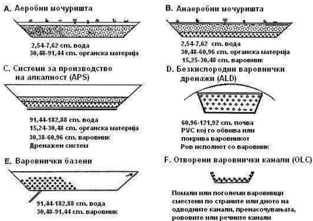
Слика 2. Шематски дијаграми на системите за пасивен третман Figure 2. Schematic diagrams of passive treatment system
