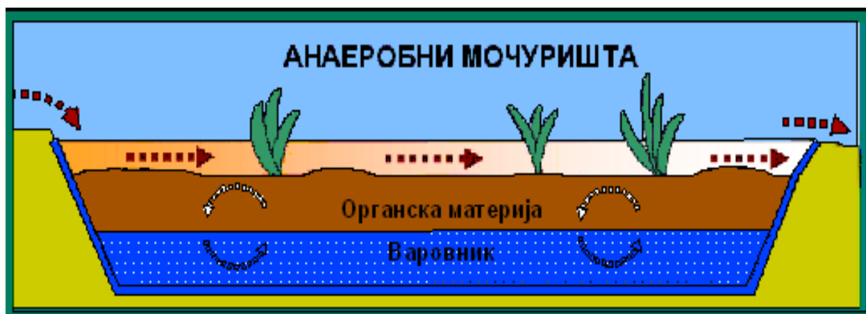
Слика 10. Поедноставен напречен пресек на анаеробно мочуриште. Figure 10. Simplified cross-sectional view of an anaerobic wetland
