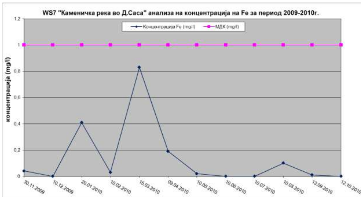
Слика 97. Концентрација на Fe во р.Каменичка кај населено место Д.Саса (WS 7) во период 2009-2010
