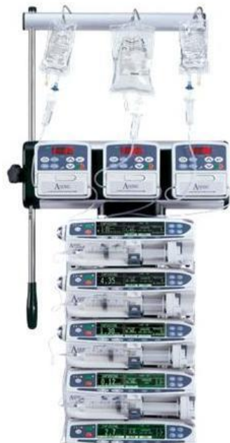
Слика 18. Збир на инфузомати и шприц пумпи за прецизно администрирање на течности и медикаменти
